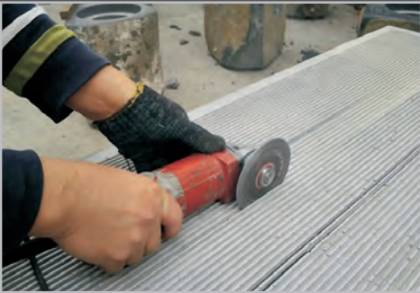
Einfacher Zuschnitt mit Winkelschleifer oder Handsäge
